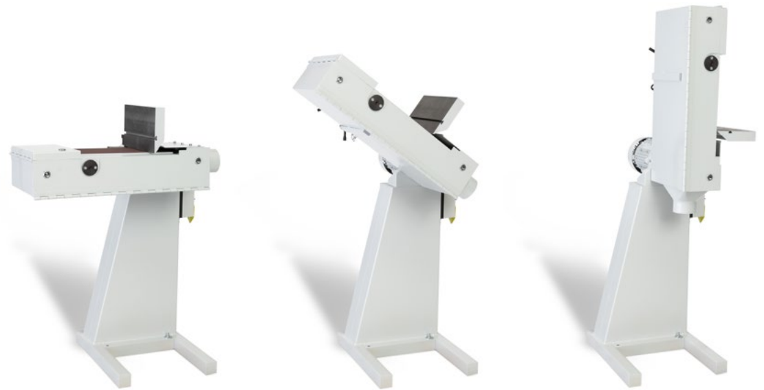
Flächenbandschleiftisch von horizontal zu vertikal verstellbar.
